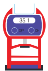
เครื่องวัดแรงบีบมือแบบมือ (Hand Grip Dynamometer)
